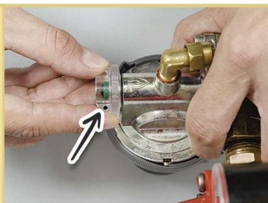
Verificar o status rearmado do dispositivo de segurança (indicador verde aparente dentro do botão de acrílico).
